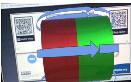
4-сурет. Тоғы бар катушқаның магниттік полюстерін анықтауға арналған визуализация Cg-physics AR
